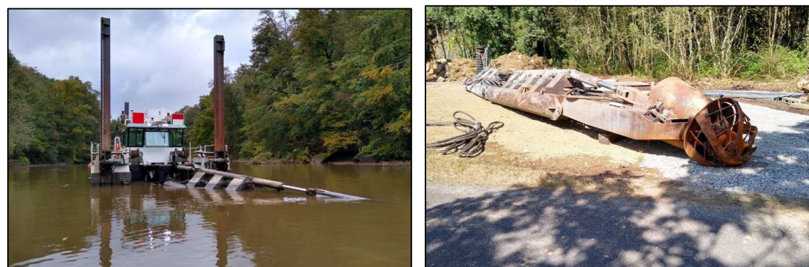
FIGURE 25 - DRAGUE ASPIRATRICE STATIONNAIRE ET SON CUTTER (SOURCE : INGEROP)
